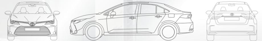
Alto\*: 1,455 mm / Ancho: 1,780 mm / Longitud: 4,630 mm / Distancia al suelo\*: 148 mm
