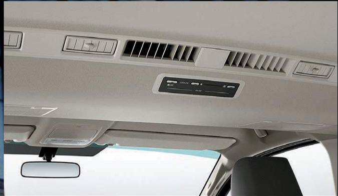
La zona delantera dispone de aire acondicionado, aire forzado y calefacción. La zona posterior cuenta con aire acondicionado y calefacción con controles independientes.
