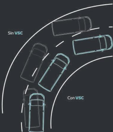
Ayuda a mantener la estabilidad direccional al virar sobre superficies irregulares con baja tracción o en pisos resbaladizos, para recuperar la adherencia y el control del vehículo.
