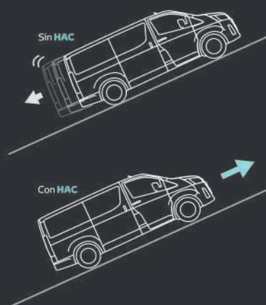
Mantiene la fuerza de freno hasta dos segundos después de soltar el pedal, para un arranque suave en pendientes inclinadas sin desplazarse hacia atrás.
