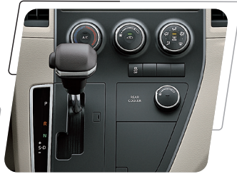
Transmisión automática con modo secuencial de 6 velocidades más retroceso (6AT)
